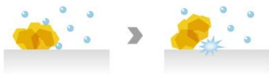
付着した汚れに侵入した気泡が破裂して汚れを剥がす
