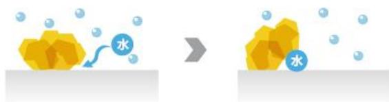
付着した汚れの間に水が浸透して汚れを浮かす
